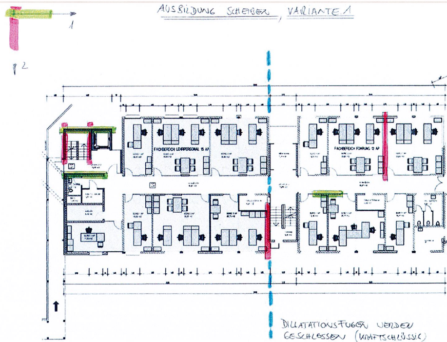
Abb.3 Variante 1: Ausbildung von Scheiben zur Erdbebenertüchtigung in Block 1 und 2 (Darstellung EG)
