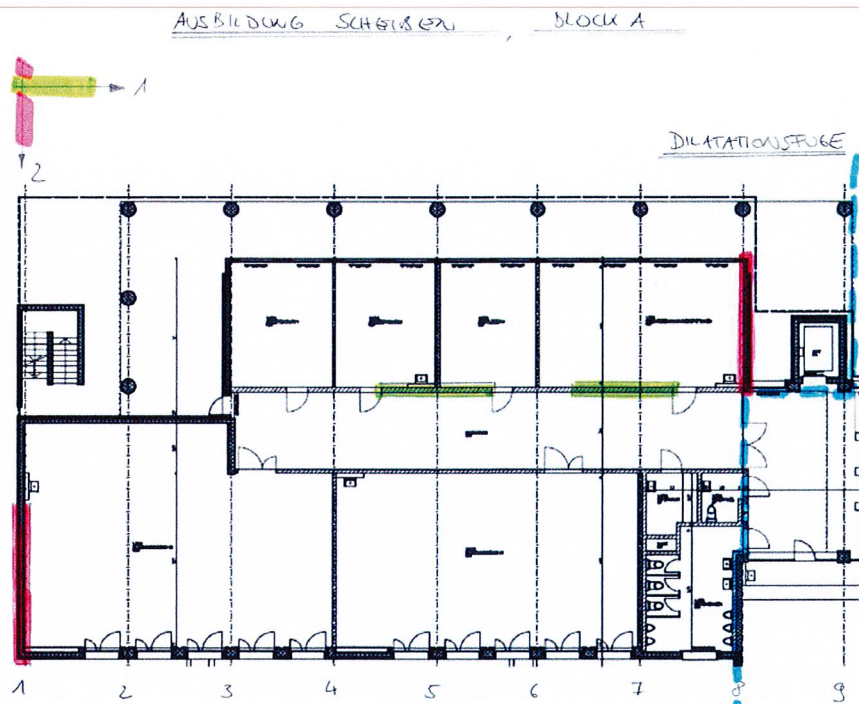
Abb.13 Ausbildung von Scheiben zur Erdbebenertüchtigung im Block A (Darstellung EG)
